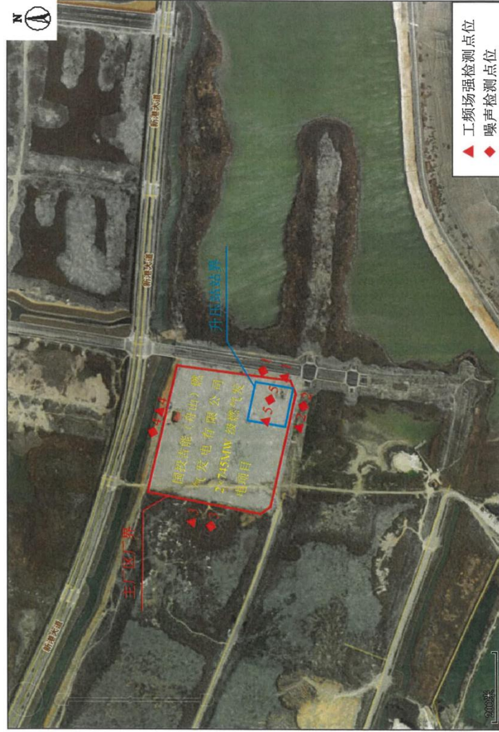
图 1 国投吉能（舟山）燃气发电有限公司 2×745MW 级燃气发电项目配套 500kV 升压站工程工频场强及噪声环境检测点位示意图 (以下空白)
