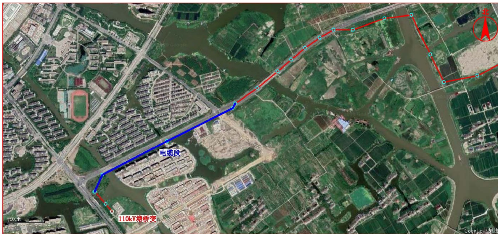
附图 8-5 110kV 建塘 1316 线电缆段路径示意图
